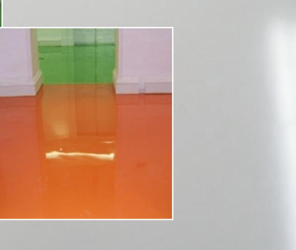
**DESCRIPCIÓN:** Pavimento multicapa continuo formado por mezcla de resinas sintéticas exentas de disolventes y árido natural de cuarzo con espesores de 3 mm, aplicado a llana dentada en varias fases con acabados lisos y decorativos.
