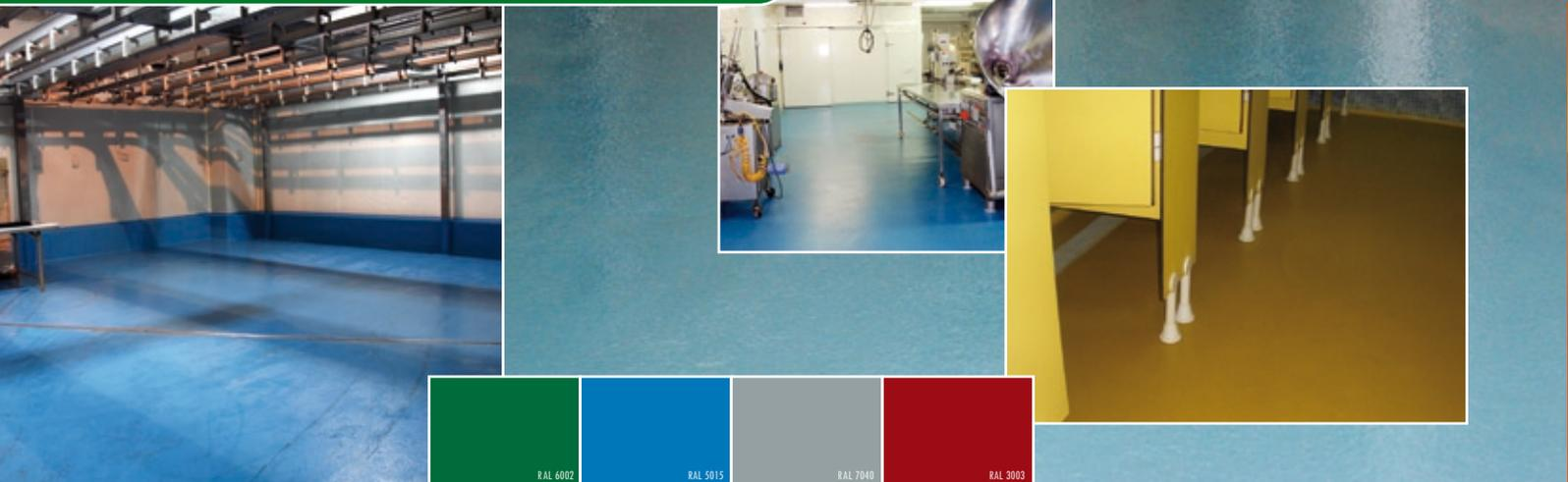
**DESCRIPCIÓN:** Pavimento multicapa continuo formado por mezcla de resinas sintéticas exentas de disolventes y árido natural de cuarzo con espesores de 3-4 mm, aplicados a llana en varias fases con acabados decorativos y antideslizantes.
