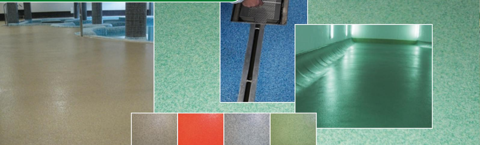
**DESCRIPCIÓN:** Pavimento multicapa continuo formado por mezcla de resinas sintéticas exentas de disolventes y cargas (áridos de colores, mármol, cristales, etc) con espesores de 3-4 mm, aplicados a llana en varias fases con acabados decorativos y antideslizantes.
